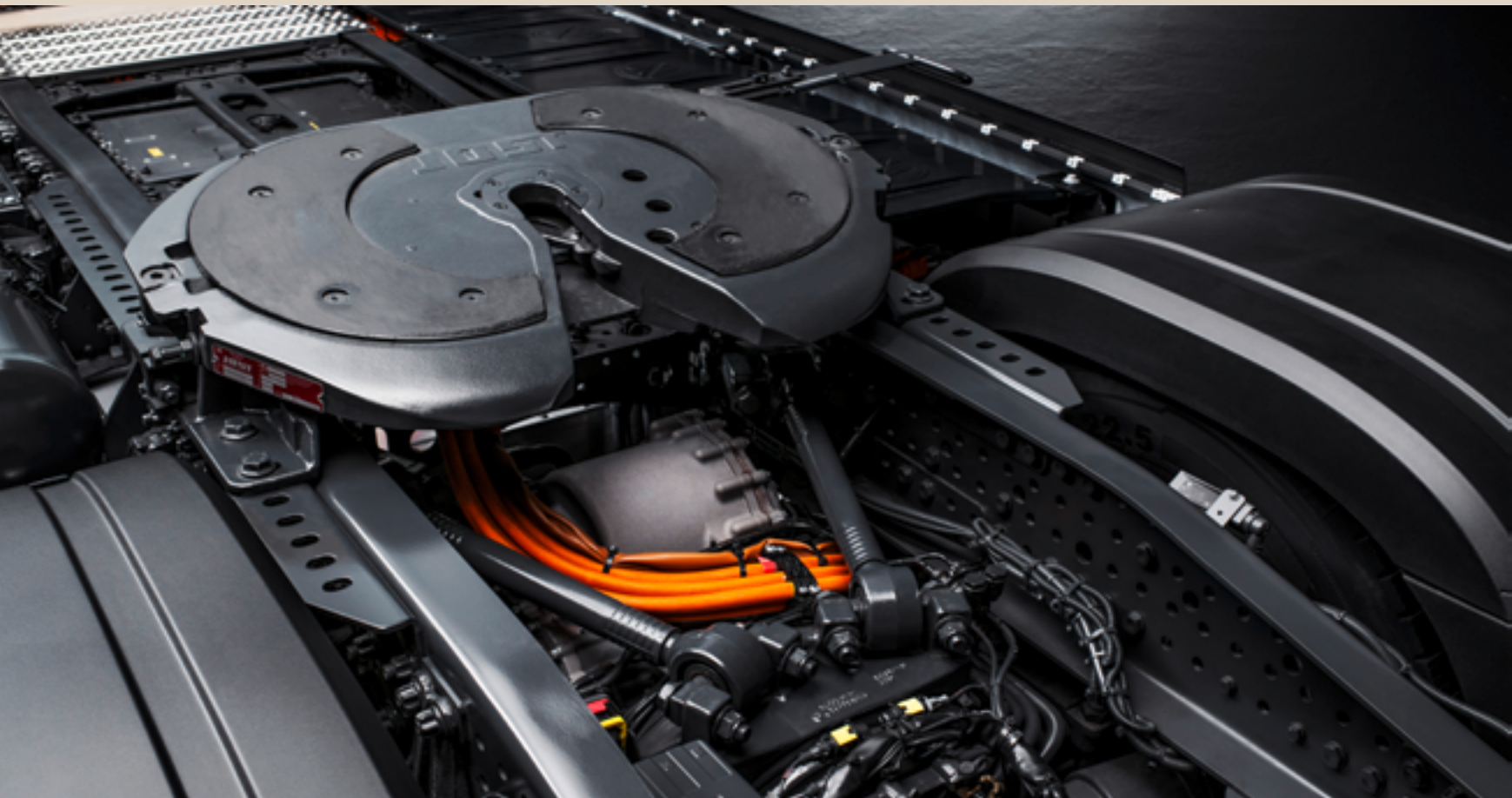
Mit seinem Li-Eisenphosphat-Antrieb erreicht der eActros starke 816 PS und kommt bis zu 500 km weit. (Foto: Daimler Truck / HJS archive)
