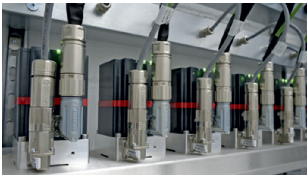
PC-based Control – Magway nutzt für seine spezifischen Anforderungen eine spezielle Variante des dezentralen Servoantriebssystems AMP8000, das auf der Schiene montiert ist.
