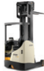
Der Crown ESR 1200 hebt bis 14,2 Meter hoch.
