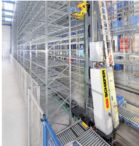
Orbiter: kombiniertes Lager- und Transportsystem für hohe Ansprüche (Foto: SSI)
