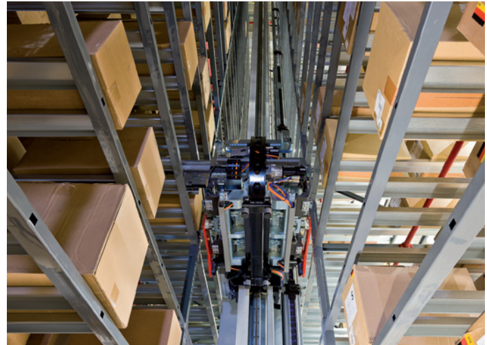
TGW Twister macht mehrfachtiefes Handling von Kartons und Behältern in verschiedenen Größen im Mischbetrieb möglich
