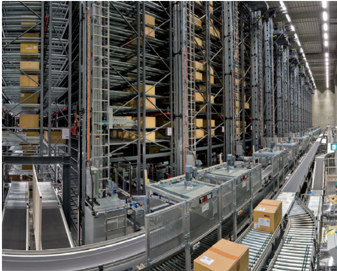
TGW Twister macht mehrfachtiefes Handling von Kartons und Behältern in verschiedenen Größen im Mischbetrieb möglich
